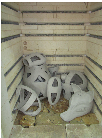
obr. 11 – nakládání lišky do pece na přežah
