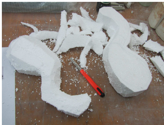
obr. 7 – vyřezávání dílů z polystyrenu
