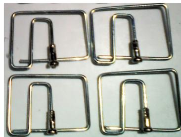
Imagen 37 Unión mano de títere-varilla roscado interno
