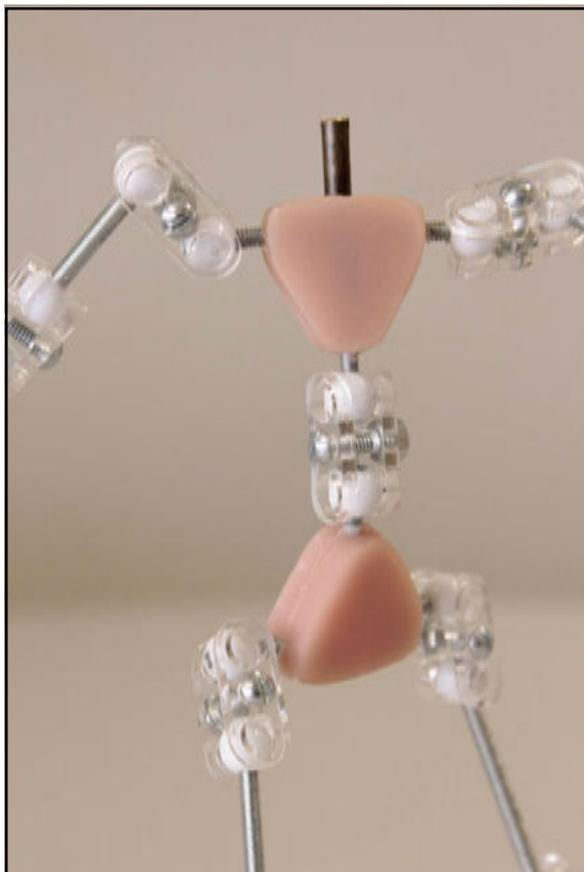
▲ Imagem 100 - Detalhe do quarto protótipo de esqueleto que utiliza esferas plásticas e peças feitas por meio de corte a laser
