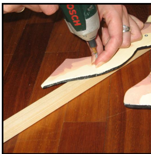
Slika 18: Pritrjevanje glavnega vodila na plosko lutko
