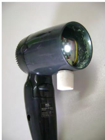
Foco adaptado com o corpo de um secador de cabelo com dimmer e luz de LED.
